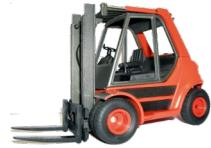
Flurförderzeuge mit einem Flüssiggas-Verbrennungsmotor – eingesetzt im gewerblichen Bereich – unterliegen der DGUV Regel 110-010 „Verwendung von Flüssiggas“. In dieser Vorschrift ist festgelegt, dass Treibgasanlagen wiederkehrend in regelmäßigen Zeitabständen, mindestens jedoch **einmal jährlich** durch eine Befähigte Person auf u. a. Dichtheit, ordnungsgemäße Beschaffenheit/ Funktion und Funktionsfähigkeit der Sicherheitseinrichtung geprüft werden.
